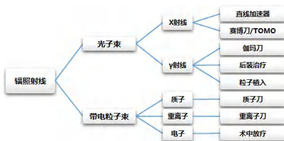
玛西普目前生产拥有自主知识产权的伽玛刀包括:第一代头部伽玛刀、第二代头部伽玛刀和体部伽玛刀三种核心产品。上述三种产品均在临床使用。伽玛刀是由机电硬件、钴源和软件组成的集成系统。机电硬件包括伽玛刀所有的机械件和电气件,比如主机、立体定位系统和软件运行所需的硬件平台。软件包括电控系统软件、治疗计划系统软件。
